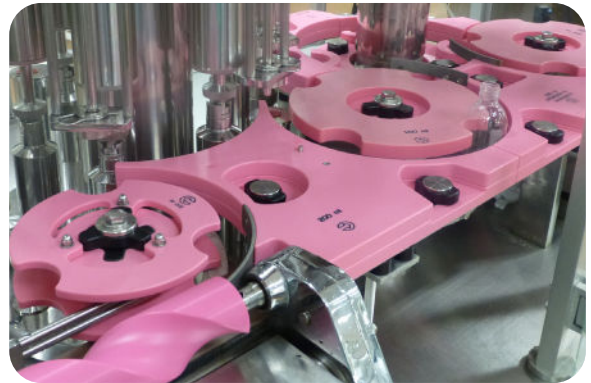
Rotobloc: Schnellwechselsystem für Formatteile, anpassbar an alle Maschinentypen
