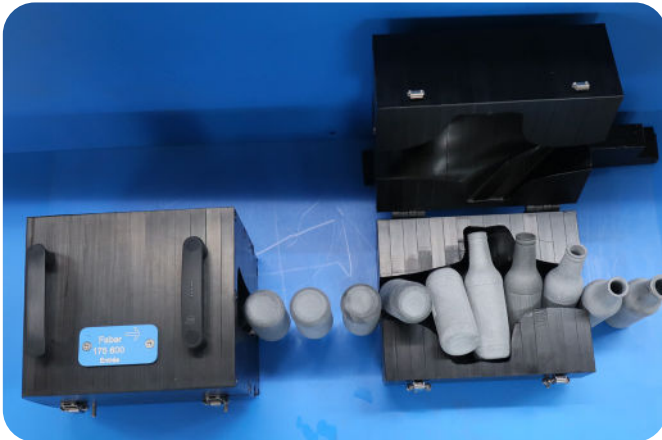
Station aus zusammengebauten Platten gefertigt
