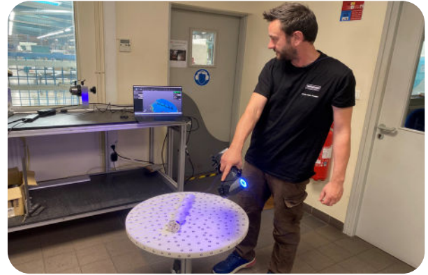
Vermessung von Teilen und Maschinenbasis mit einem 3D-Scanner
