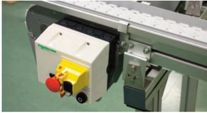
Démarrateurs directs avec disjoncteur moteur, contacteur et arrêt d'urgence pour moteur tri 400 V 50 Hz
