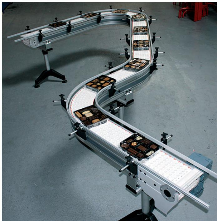
Conçus suivant vos contraintes d'implantation, les convoyeurs FlexToo® sont assemblés et testés dans nos ateliers.
