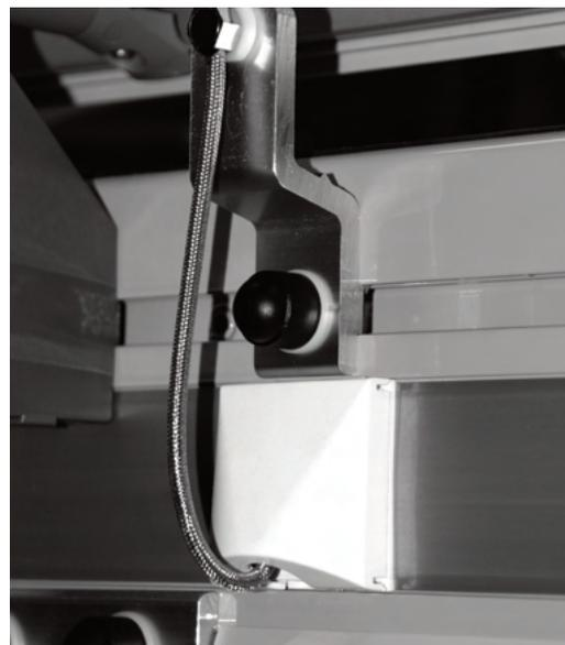
Passages de câbles intégrés au convoyeur.
