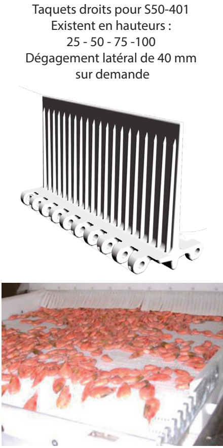
S50-401 en congélation de crevettes. L'ouverture de 61% facilite la baisse rapide de la température.
