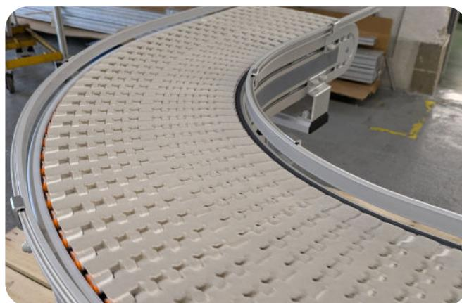
Les convoyeurs à tapis ou bandes modulaires permettent de transporter des produits de dimensions supérieures aux convoyeurs à chaînes.
