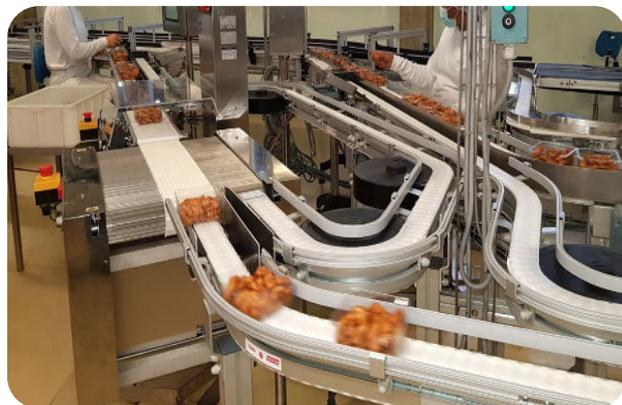
Les convoyeurs Flex, standard et économiques, sont parfaits pour le transport de charges isolées. Ils s'ajustent à tous types d'implantations et sont disponibles en modules prêts à monter ou en convoyeurs assemblés et testés en atelier. De nombreux accessoires (pieds, guides, supports) communs à nos gammes facilitent leur intégration. Compatibles avec des milliers de convoyeurs en service, ils permettent une mise en œuvre, une transformation et une évolution rapides de vos lignes actuelles.
