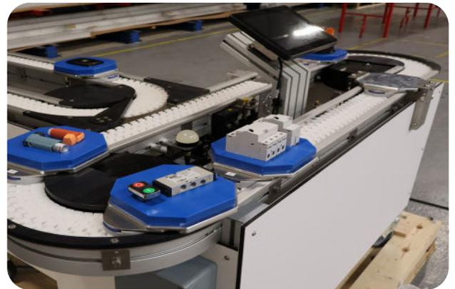
Le système de convoyage de pièces FlexTend WPC est la réponse au transport de palettes porte-pièces provenant de nombreux secteurs, tels que l'industrie automobile ou l'industrie électrique et électronique, mais aussi la cosmétique par exemple.
