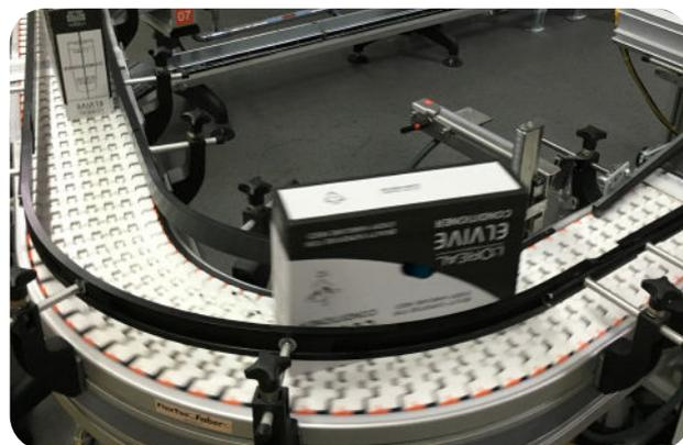
Les convoyeurs Flextoo offrent une solution polyvalente et fiable pour le transport de divers produits dans les environnements industriels. Ce convoyeur industriel est conçu avec un passage de câbles intégré à la structure aluminium du convoyeur.
