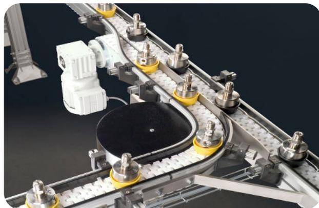
Le convoyeur FlexTend se distingue par sa robustesse, son fonctionnement silencieux et par sa conception particulièrement novatrice grâce à un fonctionnement sans brin mou de chaîne. Elle offre une efficacité maximale pour les cinématiques complexes et une sécurité optimale pour le personnel.
