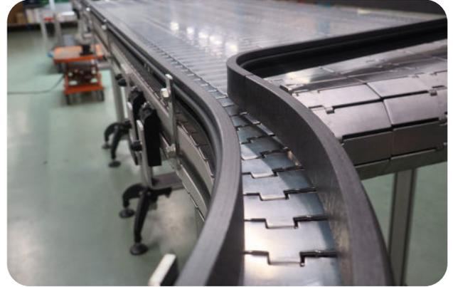
Les convoyeurs industriels Robur se déclinent en deux gammes principales. La gamme « Robur taille basse » propose des largeurs de 70 mm, 86 mm et 118 mm, offrant ainsi des options compactes adaptées aux espaces restreints. La gamme « Robur standard », quant à elle, propose des largeurs de 86 mm, 118 mm et 196 mm, répondant aux besoins de capacité accrue pour les charges plus importantes.
