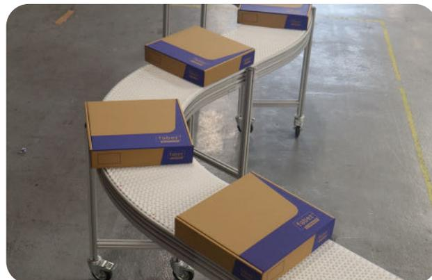
Le convoyeur industriel à tapis modulaire courbe h'ecoflex® est la solution économique, silencieuse et fiable pour le convoyage et l'accumulation de charges légères. Grâce à sa conception innovante, il est parfaitement adapté aux produits larges et offre une flexibilité exceptionnelle dans les espaces restreints.
