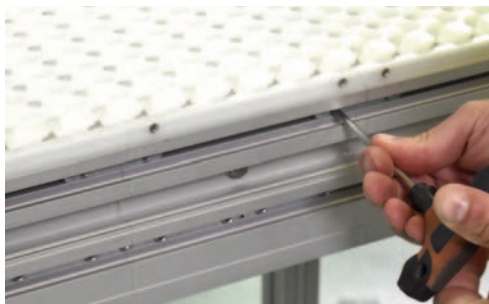
1) Desserrer les vis des 2 éclisses supérieures de la zone d'intervention (un seul côté du convoyeur suffit)
