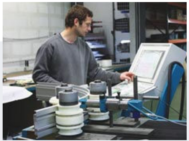
Anfertigung von Kurvenmodulen durch CNC-Biegen.
