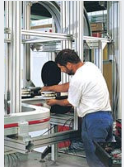
Anfertigung von Kurvenmodulen durch CNC-Biegen.
