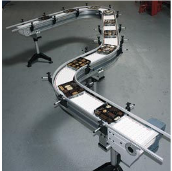
Die Förderer FlexToo® werden individuell für Ihre speziellen Einsatzbedingungen entworfen und bei uns im Werk montiert und getestet
