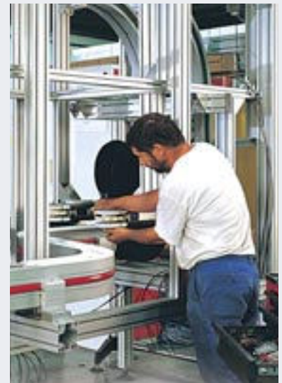
Réalisation des courbes par cintrage numérique.
