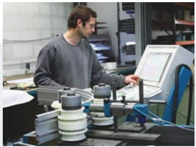
Réalisation des courbes par cintrage numérique.
