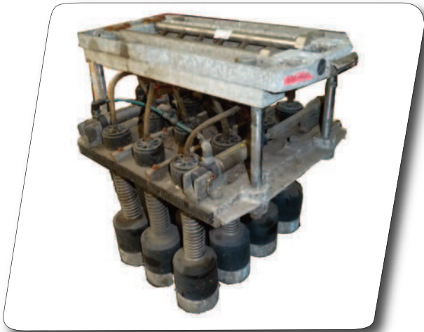
Retrofit d'une tête articulée de 12 en 3 groupes (3+6+3) avec réemploi de certaines pièces
