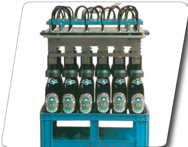
Encaissage de 3x6 bouteilles de bière (retrofit avec réemploi de certaines pièces)
